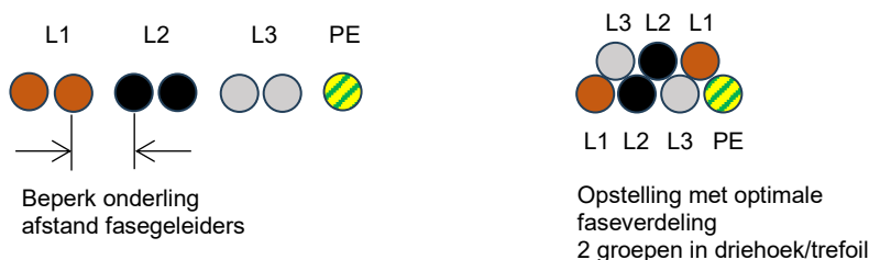
Figuur 3 Opstelling enkelfase geleiders voor LS verbindingen
